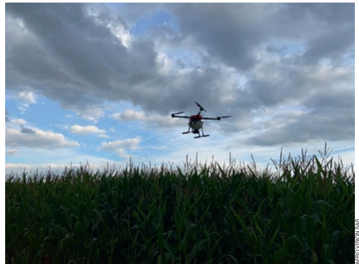
Drone de la société Aero Vision SAS en plein semis d'un mélange de couvert dans du maïs fin d'été. Le drone vole entre 5 et 10 mètres par rapport au sol en fonction de la hauteur de la culture. « En faisant différents tests, on s'est aperçu que si on vole trop bas, on peut rencontrer des problèmes d'homogénéité. La balistique des graines forme une sorte de parapluie. Trop bas, on n'atteint pas la bonne largeur de couverture », indique Arnaud Sohler.
